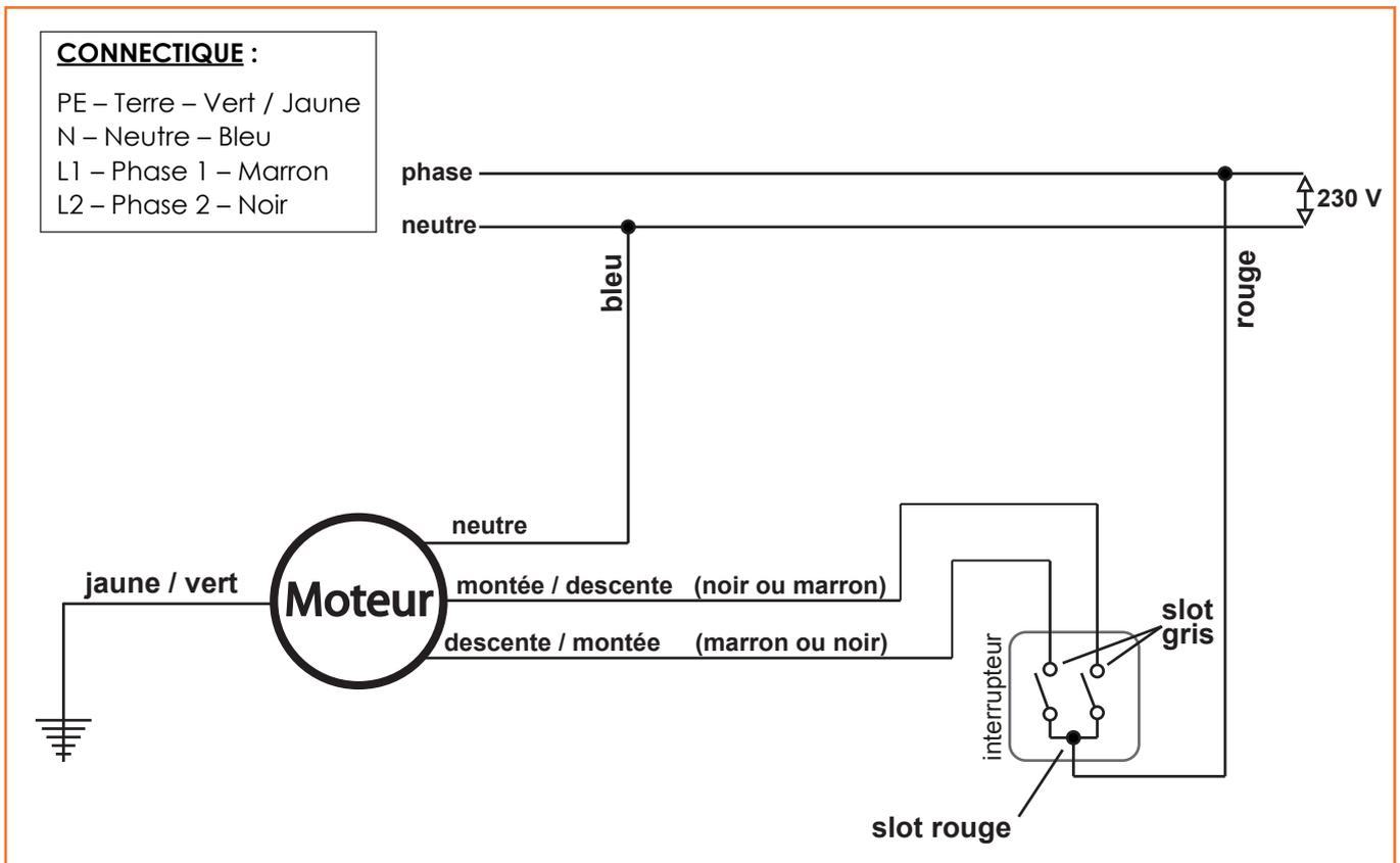
*Note : Vous devez appuyer sur les slots gris et rouges situés au dessus du mécanisme de l'interrupteur afin de pouvoir enclencher vos câbles électriques sur le côté de celui-ci.*
