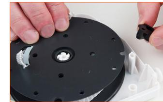
**10** - Refermez le boîtier grâce aux 2 pièces et repoussez les ergots en position fermée.
