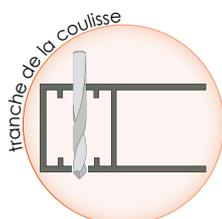
2 - Percez de nouveau la première épaisseur des coulisses à un diamètre supérieur à celui de vos têtes de vis. Cela vous permettra de passer les vis à l'intérieur des coulisses, et donc de ne pas gêner la descente du volet.
