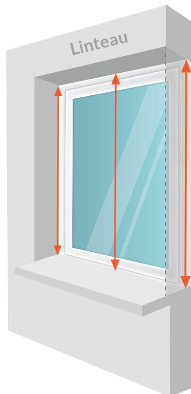
Mesurez la hauteur entre le linteau et le sol en 3 points : à gauche, au milieu et à droite.
