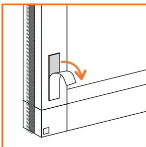
Retirez les bandes de protection des velcros adhésifs préinstallés sur le cadre
