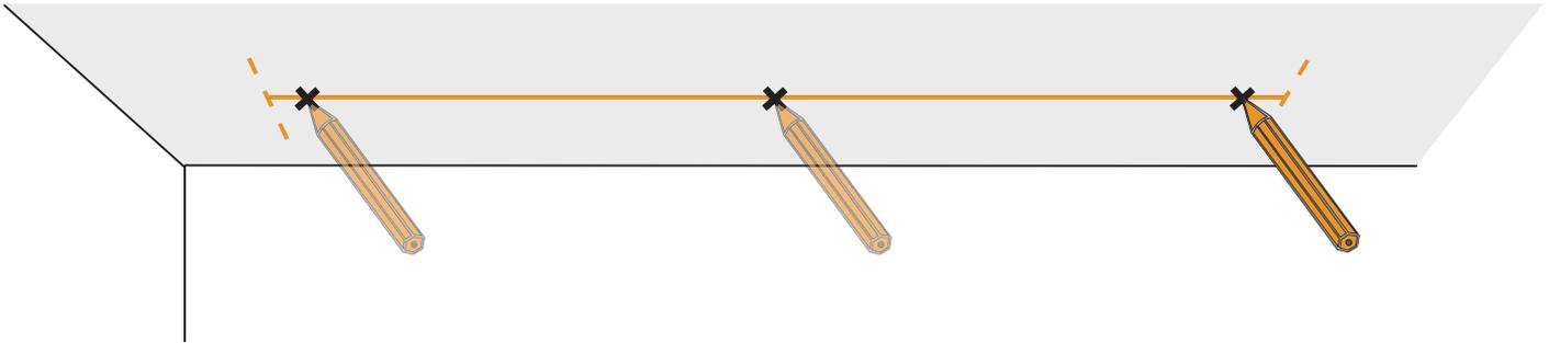
3 - Fixez les clips au plafond en positionnant le levier de verrouillage vers la fenêtre :
