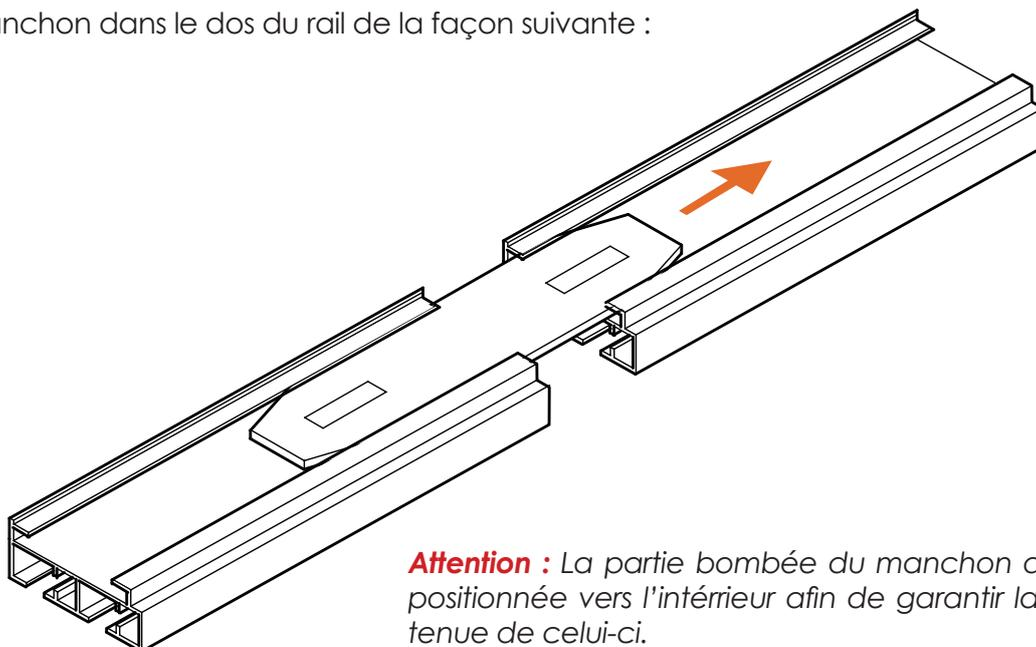
**Attention :** La partie bombée du manchon doit être positionnée vers l'intérieur afin de garantir la bonne tenue de celui-ci.
