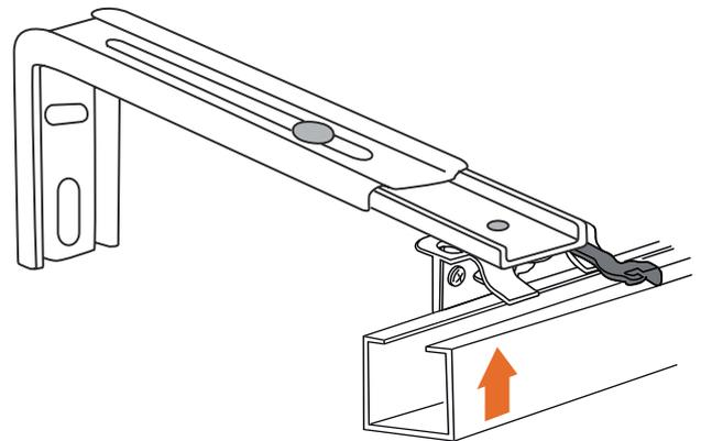
Inclinez le caisson vers l'arrière et glissez-le dans les fixations
