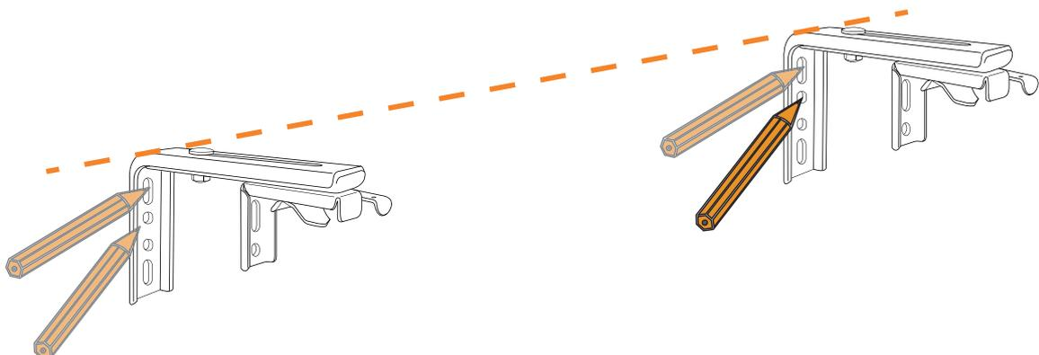
*Conseils : Positionnez une fixation à quelques centimètres de chaque extrémité puis répartissez le reste des fixations équitablement le long du mur.*
