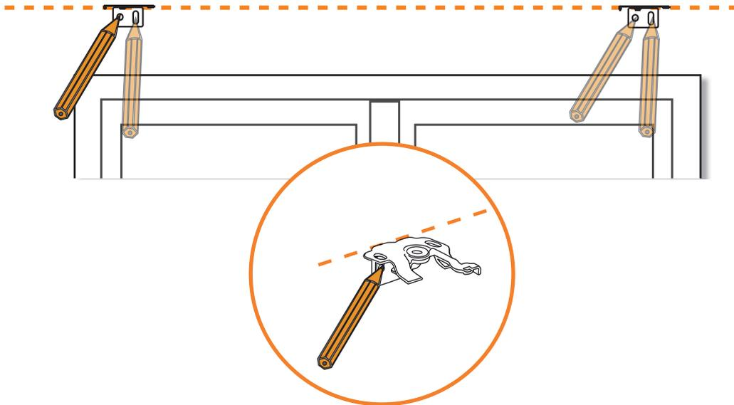
*Conseils : Positionnez une fixation à quelques centimètres de chaque extrémité puis répartissez le reste des fixations équitablement le long de la ligne tracée.*
