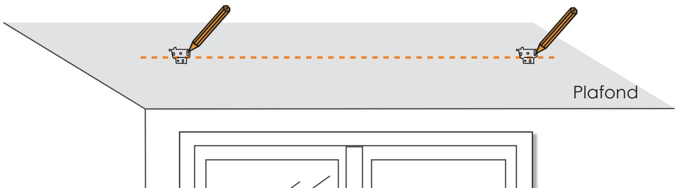
*Conseils : Positionnez une fixation à quelques centimètres de chaque extrémité puis répartissez le reste des fixations équitablement le long de la ligne tracée.*
