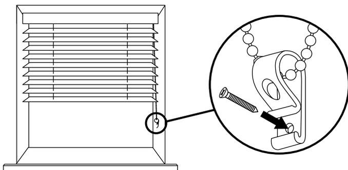
Le tendeur de chaîne fourni dans le colis doit être positionné de façon à bien tendre la chaîne et ainsi éviter qu'elle ne s'enlève du bloqueur.
