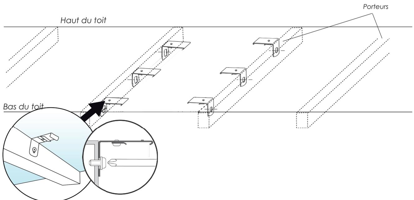
**1. Les équerres sont calées dans l'angle obtenu par la vitre et le porteur.**
