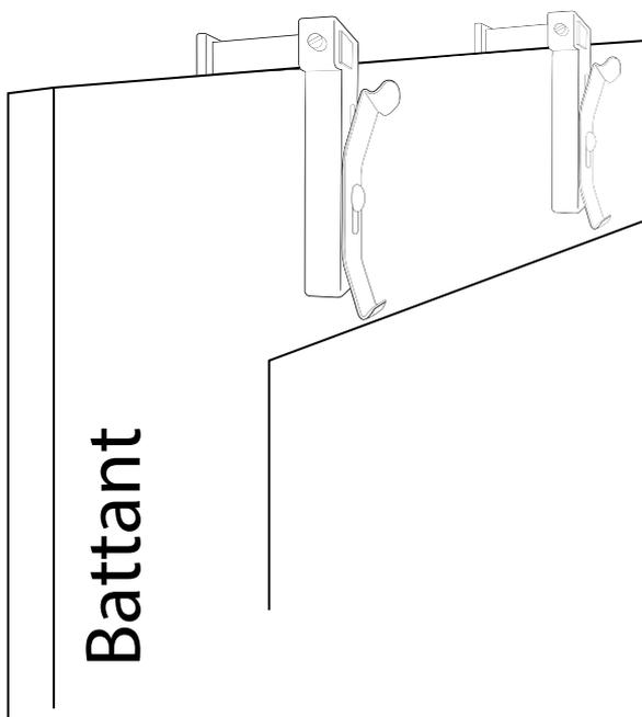
2 - Une fois ajustée, serrez la vis se trouvant sur la fixation plastique.
