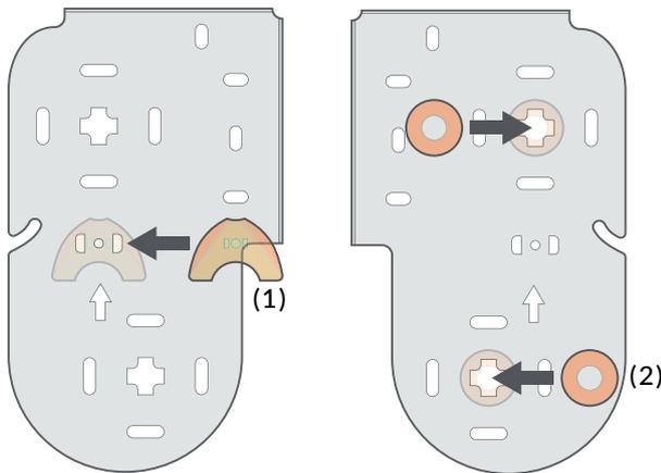
1 - Sur le support de la commande du store, insérez le guide-chaîne dans les fentes correspondantes au milieu du support.
