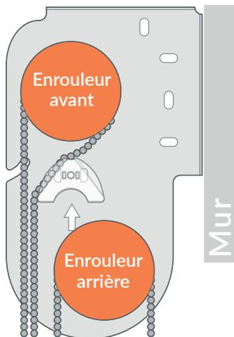
Prenez la chaîne du store enrouleur le plus haut (le store avant) et placez la partie arrière de la chaîne sur le guide-chaîne, de sorte que la chaîne soit positionnée vers l'avant et ne s'emmêle pas avec la chaîne de l'autre store enrouleur.
