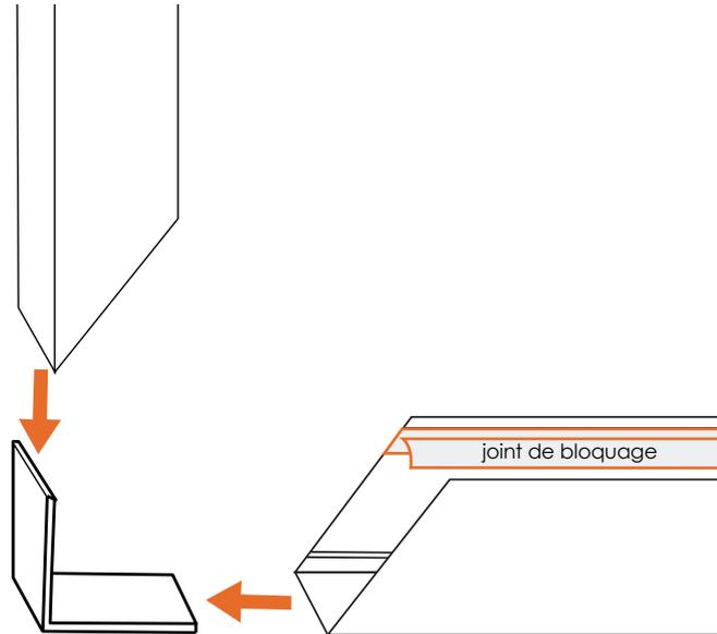
**Attention :** Le joint permettant le blocage de la moustiquaire en position basse doit être positionné vers l'extérieur de votre pièce. C'est à dire sur le côté de la coulisse qui sera vers la fenêtre de toit.
