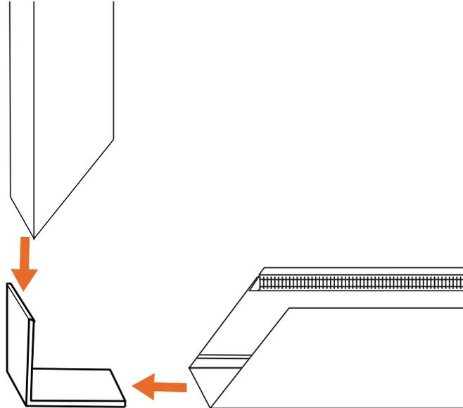
2 - Percez les coulisses et les clames à 1 cm de chaque bord (diamètre de perçage 4 mm et mettez les rivets.
