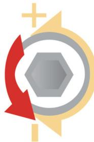
Ajustez la position en tournant la vis vers le « + » (sens anti-horaire) jusqu'à ce que le volet atteigne la position souhaitée
